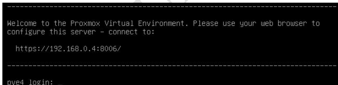
Gambar 5.25 Hasil Instalasi Proxmox VE pada Server PVE4
